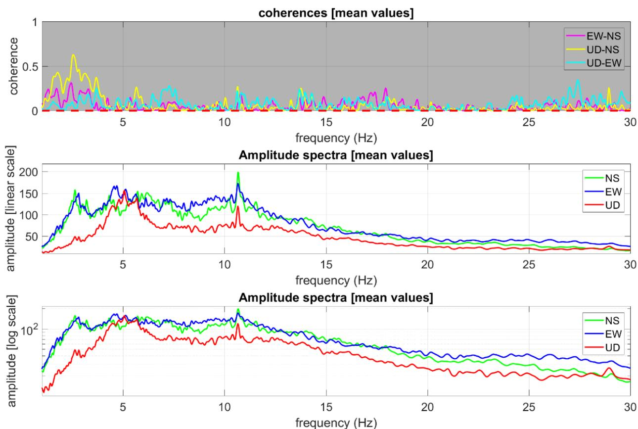
Dall'alto: funzioni di coerenza per le tre coppie di sensori indicati, spettri di ampiezza medi (*smoothing 1%*) con scala verticale lineare, spettri di ampiezza con scala verticale logaritmica.
