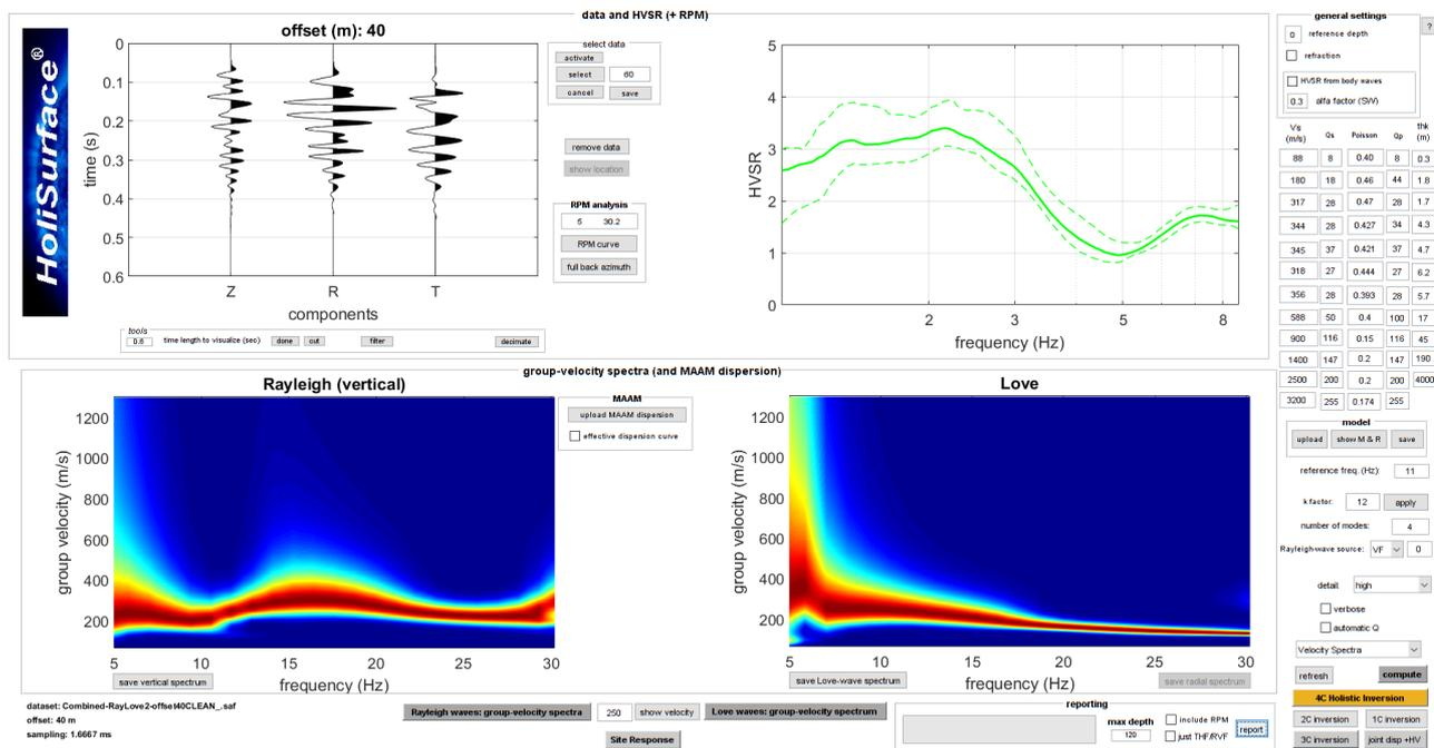
I tre *observables* utilizzati per l'inversione congiunta. Dall'alto a sinistra (in senso orario): le tracce sismiche attive (componenti Z R e T), curva HVSR e spettri delle velocità di gruppo delle componenti Z e T.
