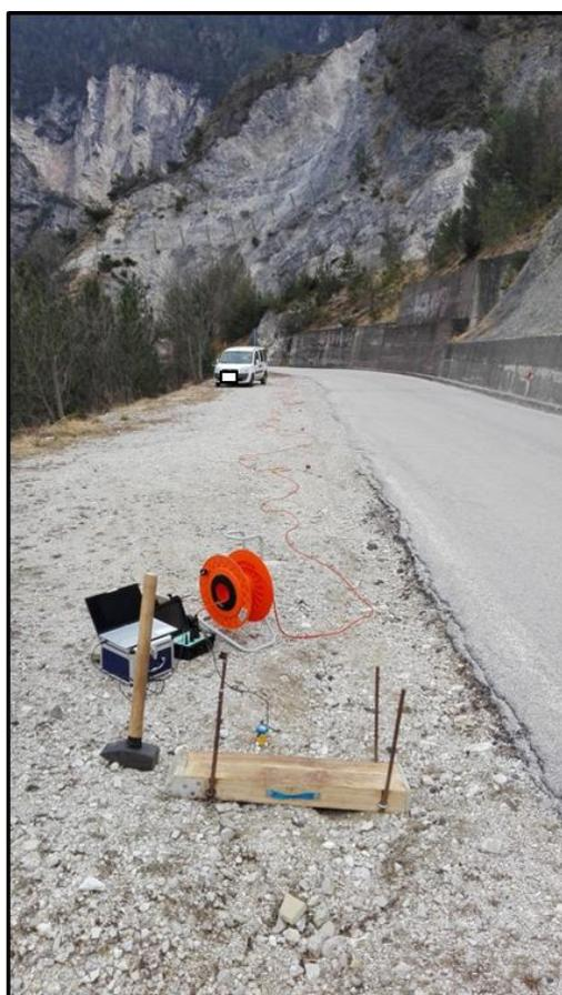
**Figura 6.** Lo stendimento MASW multi-offset (con geofoni orizzontali su tripodi) e traversina in legno per battuta orizzontale (HF - *Horizontal Force*) utile a generare le onde di Love [sistema di acquisizione *HoliSurface*® utile anche ad acquisire dati per analisi HS, HVSr, vibrazionali, eccetera].
