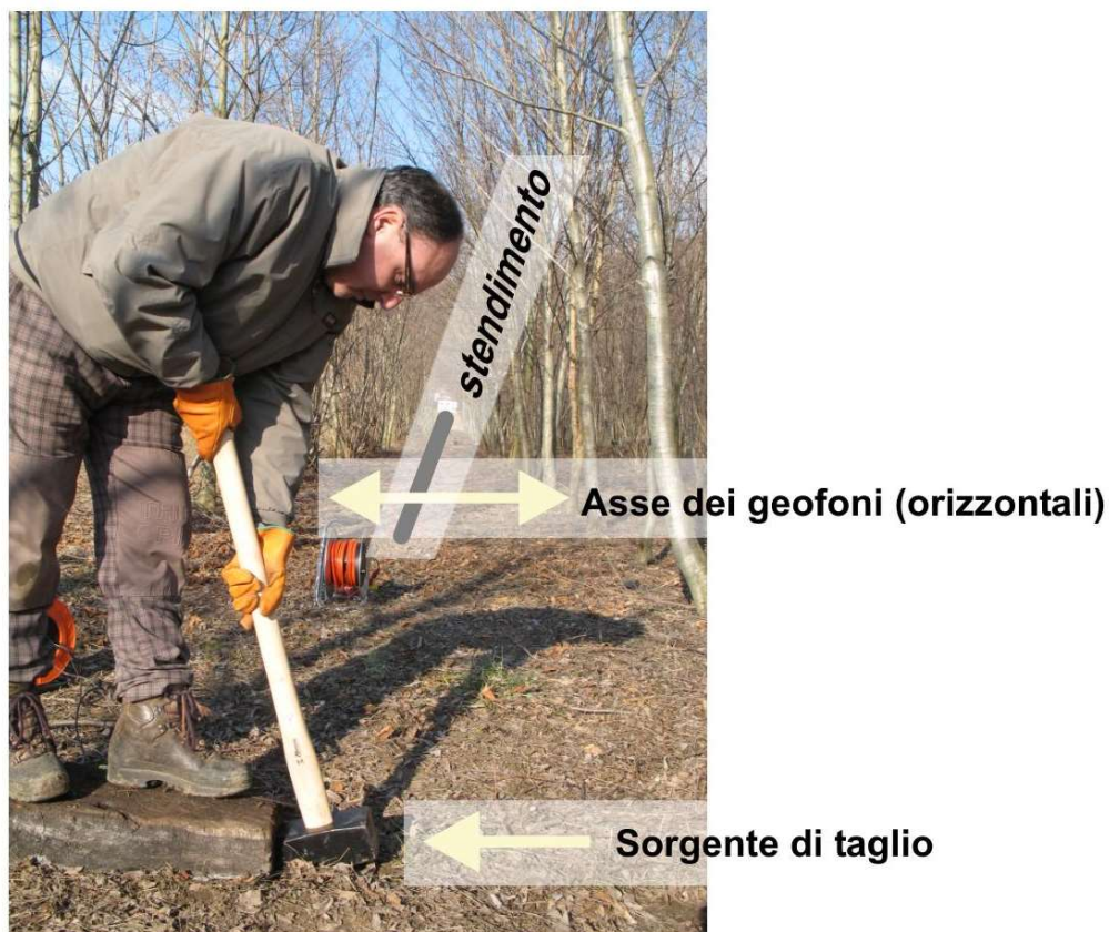
Figura 3. Acquisizione di dati utili ad analizzare la rifrazione delle onde SH e delle onde di Love (indicata la direzione dell'asse di sensibilità dei geofoni, perpendicolare allo stendimento – vedi anche Figura 2).
