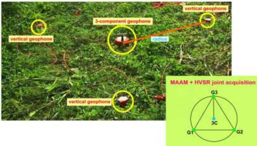
Analisi congiunta degli spettri di velocità di gruppo delle componenti verticale e radiale congiuntamente al rapporto spettrale H/V
