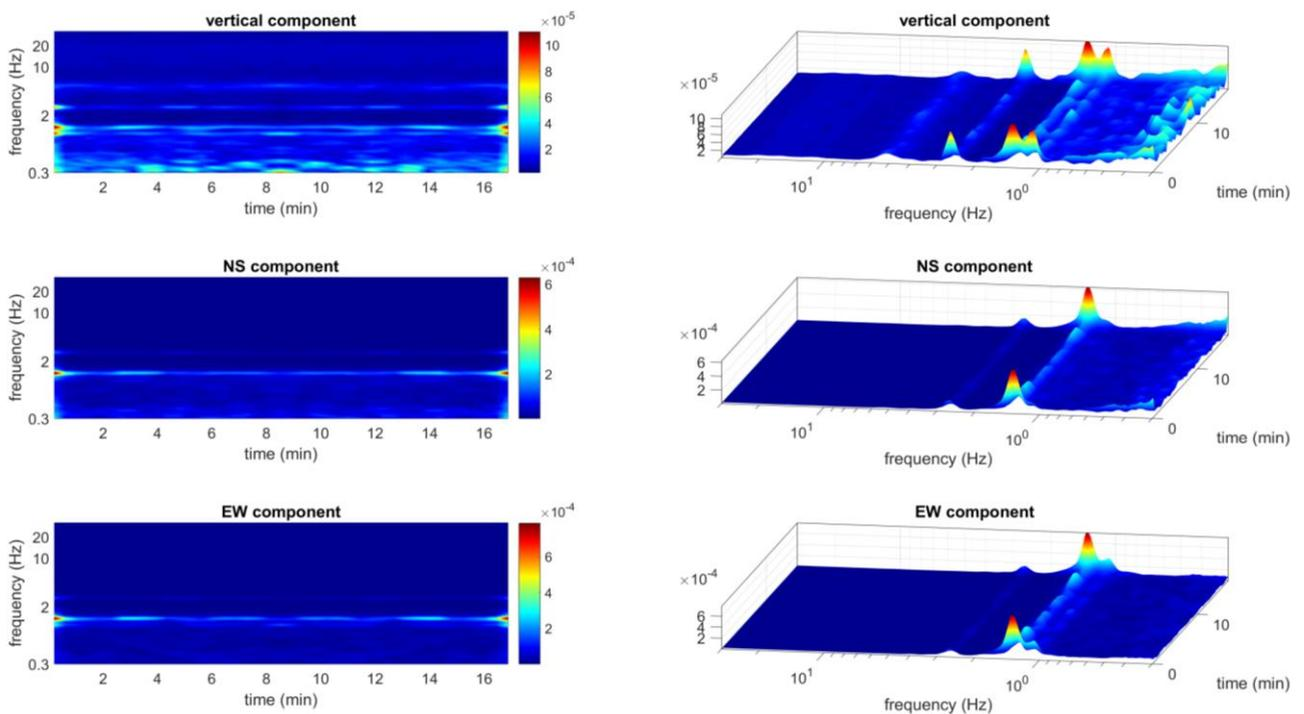
Continuità temporale delle tre componenti (UD, NS, EW) [spettri di ampiezza in funzione del tempo]: evidenti i segnali di natura industriale attorno a 1.4 e 2.7Hz posti in ulteriore evidenza dagli spettri di ampiezza medi e dalle funzioni di coerenza riportate nella successiva figura.
