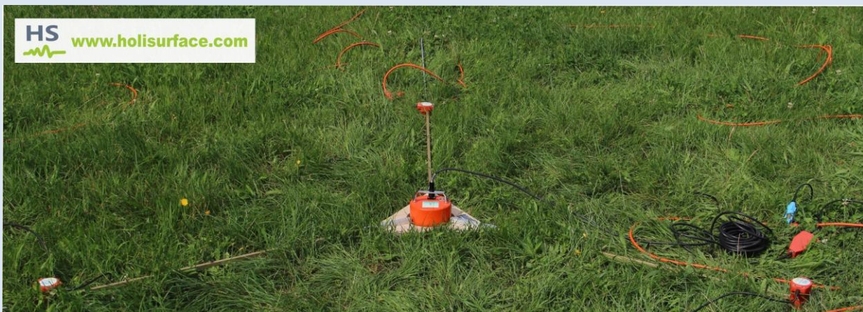
Dispositivo AREA51 per acquisizioni MAAM
