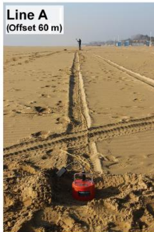
Figura 3.3 Stendimento HS: in primo piano il geofono a 3 componenti, in lontananza la sorgente.
