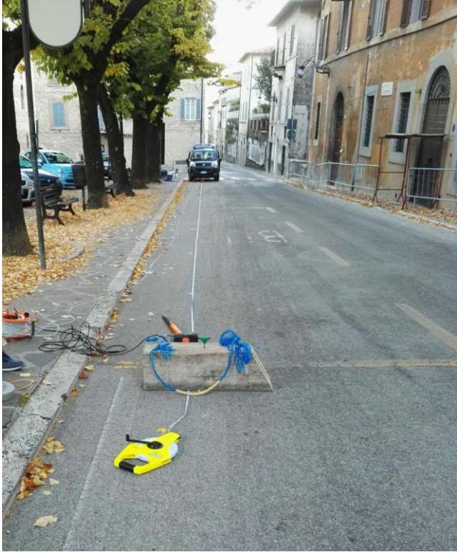
Figura 3. Battuta trasversale (HF - Horizontal Force ) per la generazione delle onde di Love (qui non considerate in virtù della chiarezza delle onde di Rayleigh considerate).
